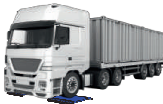
SOLUTION 2 Peser le conteneur en le soulevant à l'aide de vérins posés sur les plateformes.
