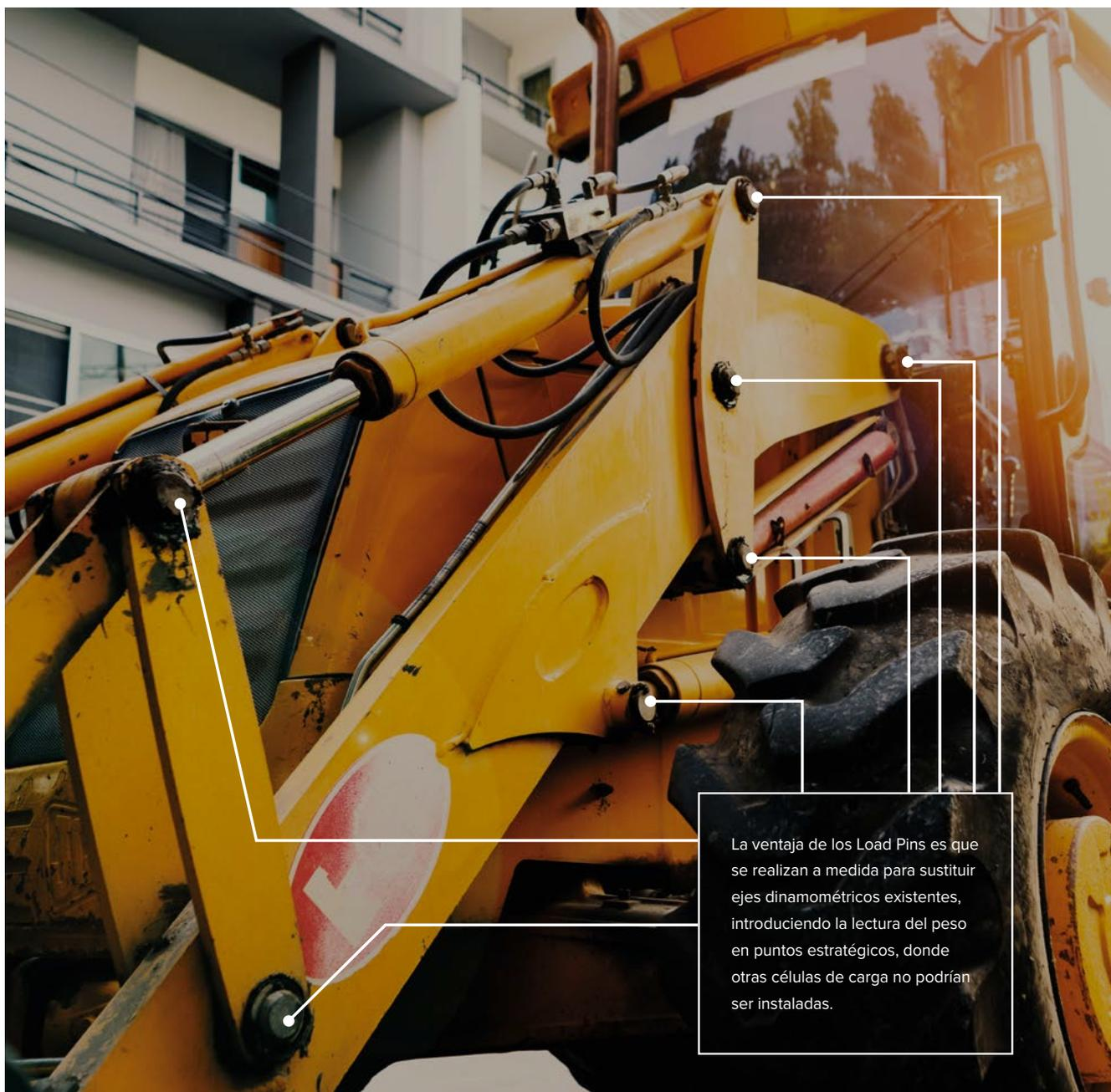
La ventaja de los Load Pins es que se realizan a medida para sustituir ejes dinamométricos existentes, introduciendo la lectura del peso en puntos estratégicos, donde otras células de carga no podrían ser instaladas.
