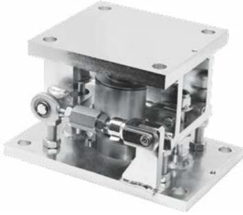
Montagesatz für Pendel-Wägezellen Serie RL5426 und RL5426DC bis 40.000 kg. Einsetzbar zum Wiegen von Silos, Tanks und Trichtern großen Wägebereichs.
