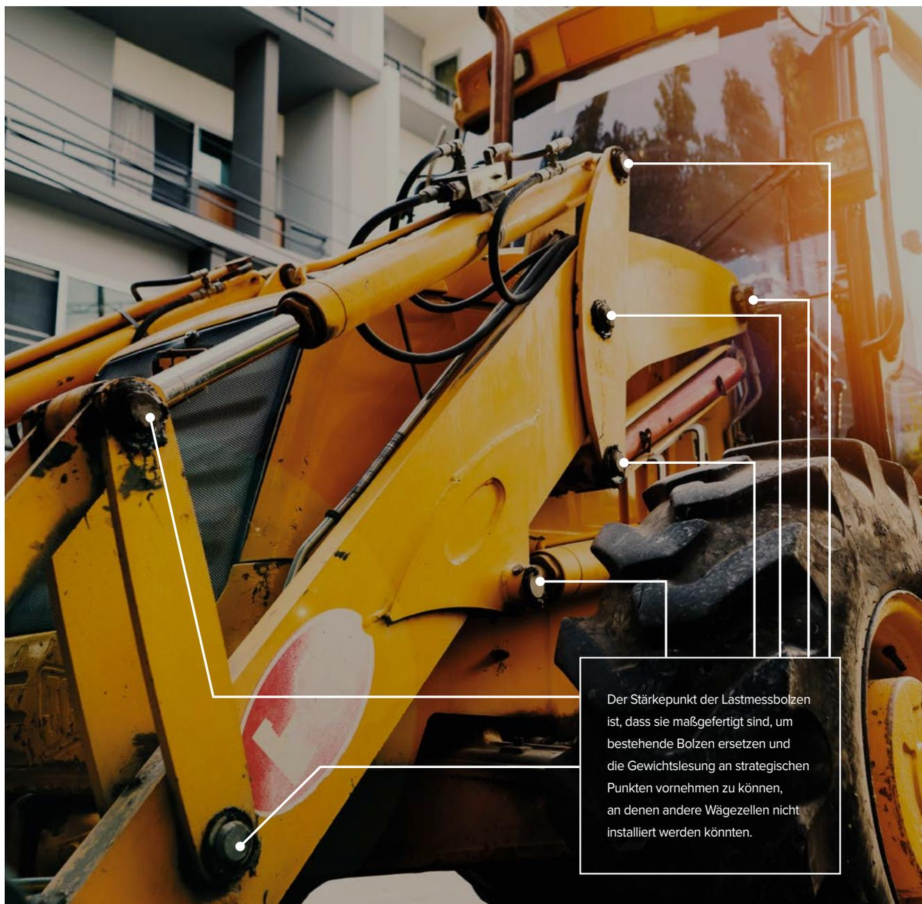
Der Stärkepunkt der Lastmessbolzen ist, dass sie maßgefertigt sind, um bestehende Bolzen ersetzen und die Gewichtslesung an strategischen Punkten vornehmen zu können, an denen andere Wägezellen nicht installiert werden könnten.
